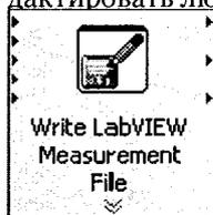
**Write LabVIEW Measurement File**—Запись в lvm-файл. Входные данные (скалярная величина, массив, осциллограмма, набор осциллограмм) подаются на терминал **Signals**, имеющий динамический тип (см. лекцию 16) В диалоге имеется возможность настроить:
